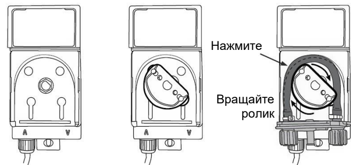
Рис. 3. Установка держателя и дозирующего шланга в насос
