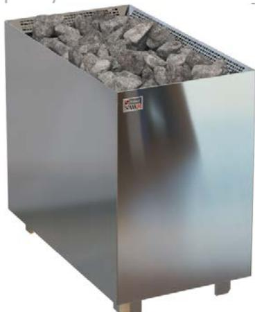
Электропечь SAWO NRNF-180NS-V12-Z – это надежное устройство мощностью 18 кВт, которое идеально подходит для обогрева саун объемом от 18 до 30 кубических метров. Благодаря использованию высококачественной нержавеющей стали и оцинкованного металла, эта модель отличается долговечностью и устойчивостью к коррозии. Кроме того, она оснащена вместительным контейнером для камней весом 75 кг, что позволяет создавать оптимальный микроклимат в помещении паровой бани.
